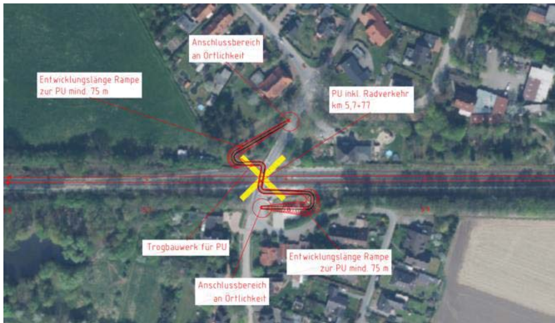
Abbildung 4: Tunnel als Quermöglichkeit für Radfahrer und Fußgänger in Walle 4
