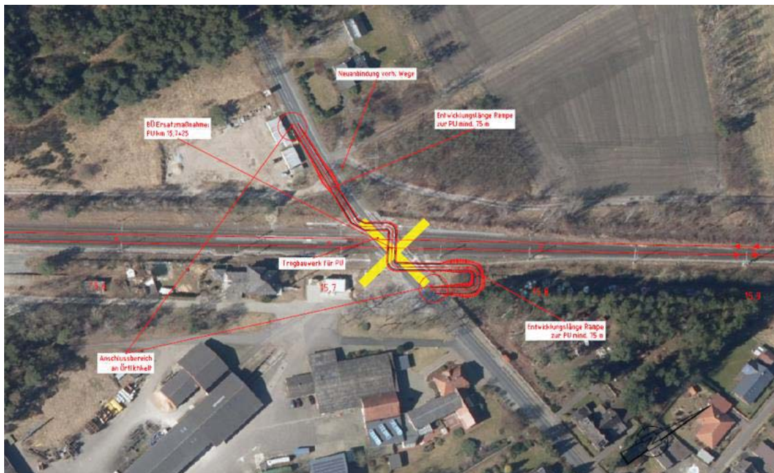
Abbildung 11: Tunnel als Quermöglichkeit für Radfahrer und Fußgänger in Westerwalsede 11
