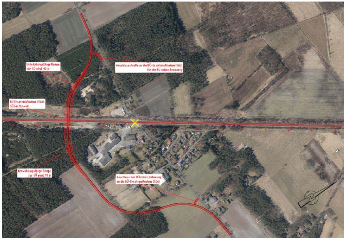
Abbildung 10: Schließung Bahnübergang in Westerwalsede inkl. Ersatzmaßnahme (Straßenüberführung) 10
