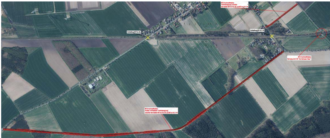
Abbildung 8: Variante G2 für die Schließung der BÜ 9,635 Holtum I, „Föscheberg K21“ und BÜ 10,779 Holtum II, „Holtumer Dorfstraße K11“ 8
