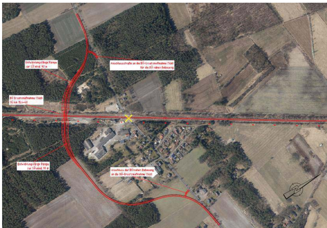
Abbildung 3: Schließung Bahnübergang in Westerwalsede inkl. Ersatzmaßnahme (Straßenüberführung)
