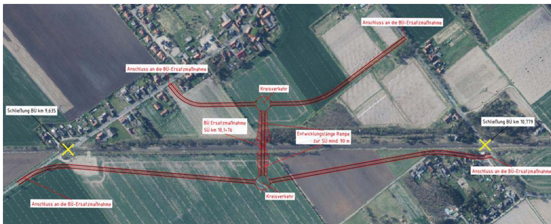
Abbildung 7: Variante G1 für die Schließung der BÜ 9,635 Holtum I, „Föscheberg K21“ und BÜ 10,779 Holtum II, „Holtumer Dorfstraße K11“ 7
